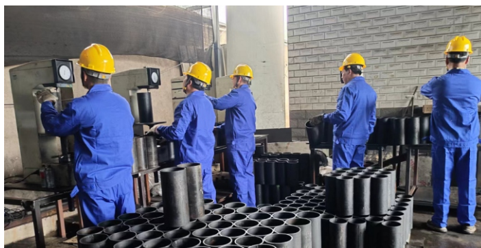
▲ 内管淬火--淬火炉温 860 \pm 10^{\circ}\text{C} ， 油温 45-70^{\circ}\text{C} ，时间210S
