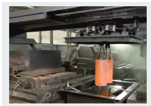
▲ 内管淬火--淬火炉温 860 \pm 10^{\circ}\text{C} ， 油温 45-70^{\circ}\text{C} ，时间210S
