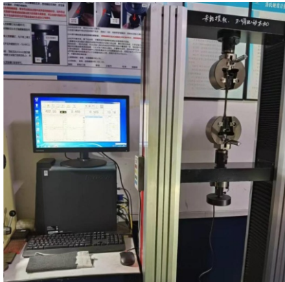
▲ 外管拉伸力学性能检测
