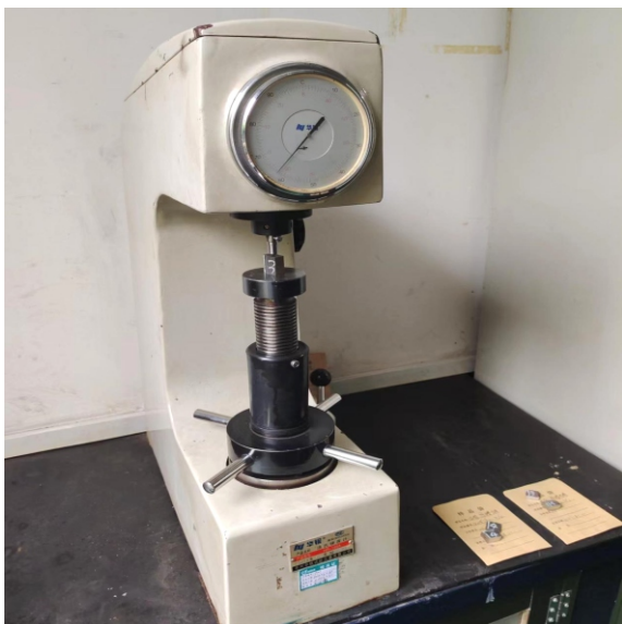
▲ 铸铁淬火后硬度检测
